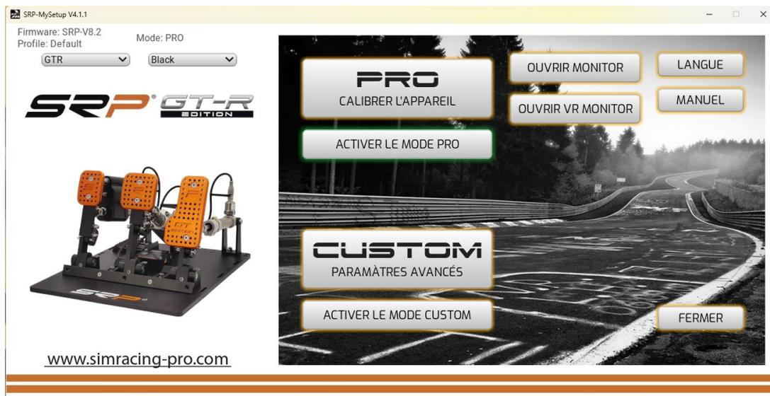
**Paramètres de base PRO :** Dans cette section, vous pouvez calibrer les pédales, régler les zones mortes, modifier la pression de freinage en temps réel, attribuer des boutons à cartographier sur votre panneau de boutons ou votre volant, enregistrer et charger des profils personnalisés.
