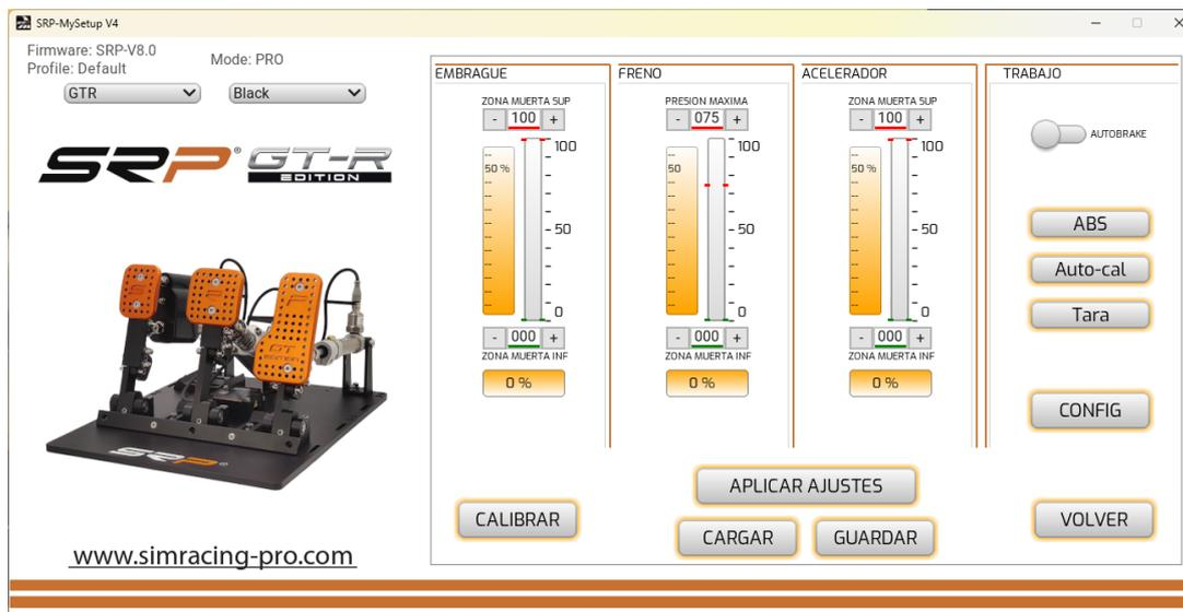
**APLICAR AJUSTES:** Guarda el perfil en la placa como predeterminado.
