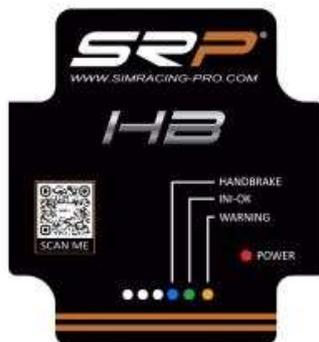
POWER: Led rojo, indica que la placa tiene alimentación por USB.
